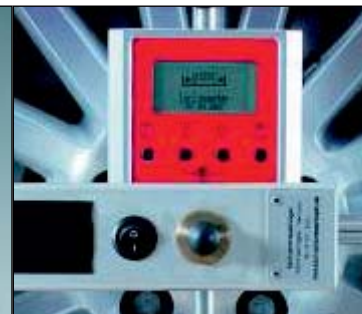
Digitale hoekmeter met rekenfunctie
